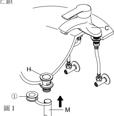
依序將V套入W與X內孔中，裝進壁上排水孔，固定方向(如圖I)。
