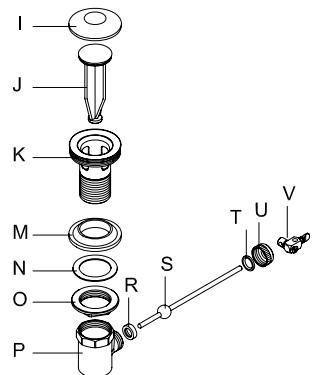
將 K 置於臉盆的落水孔上，依序裝上 M、N、O，並鎖緊 O，使 K 緊固於臉盆上(如圖 I )。把 K 繩上止洩帶，將 P 鎖緊於 K 並固定方向，再將 Q 繩上止洩帶並鎖緊於 P(如圖 II )。
