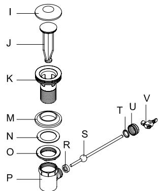
將K置於臉盆的落水孔上，依序裝上M、N、O，並鎖緊O，使K緊固於臉盆上(如圖I)。把K纏上止洩帶，將P鎖緊於K並固定方向，再將Q纏上止洩帶並鎖緊於P(如圖II)。
