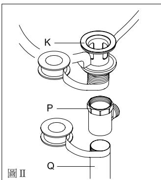
依序把R、S、T及U鎖緊於P上(如圖I)。依序把V裝入S、W。將W鎖緊V，並用一字螺絲起子③把V鎖緊於S。使W可靈活控制J上下的作動，並有效的止水。(如圖II)。
