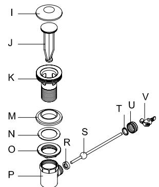
將K置於臉盆的落水孔上，依序裝上M、N、O，並鎖緊O，使K緊固於臉盆上(如圖I)。把K纏上止洩帶，將P鎖緊於K並固定方向，再將Q纏上止洩帶並鎖緊於P(如圖II)。
