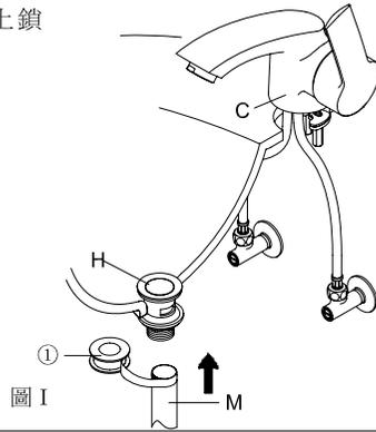
依序將V套入W與X內孔中，裝進壁上排水孔，固定方向(如圖 I)。
