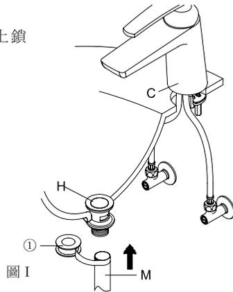
依序將V套入W與X內孔中，裝進壁上排水孔，固定方向(如圖 I)。
