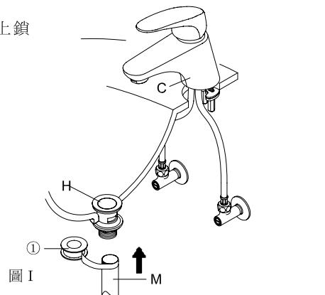
依序將V套入W與X內孔中，裝進壁上排水孔，固定方向(如圖 I )。
