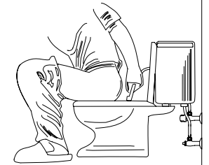
安裝後沖洗情形
