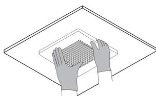
**1** 將面板從本體中拆下。一手將面板壓住另一手伸入面板的凹槽中往下拉。
