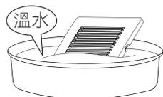
**3** 面板先放入加有中性清潔劑的溫水(60°C以下)中浸泡後再清潔。完成後用軟布擦乾或風乾。
